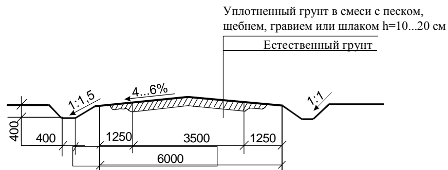
Рис. 7.1. Профиль временной грунтовой дороги с улучшенным покрытием
